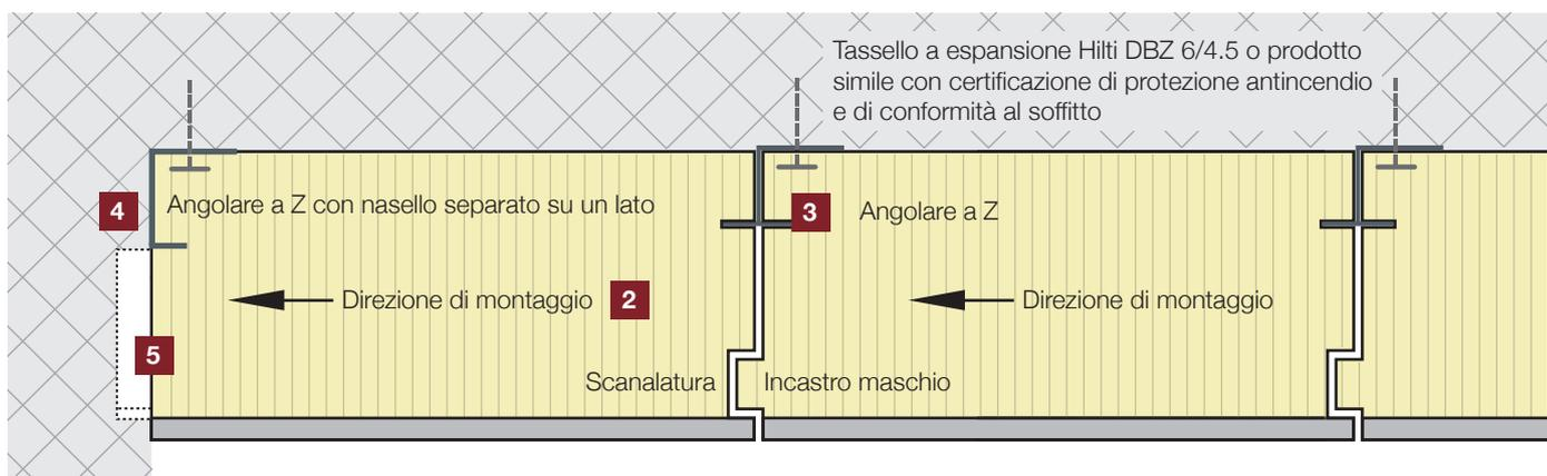
Per pannello vengono utilizzati due angolari a Z.
