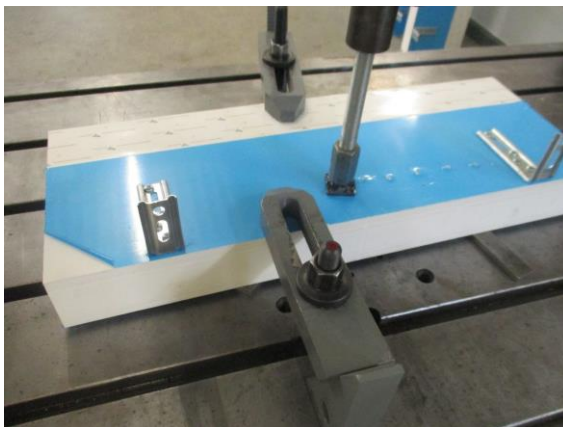
Einbau Schraubenauszug / Installation extraction par vis
