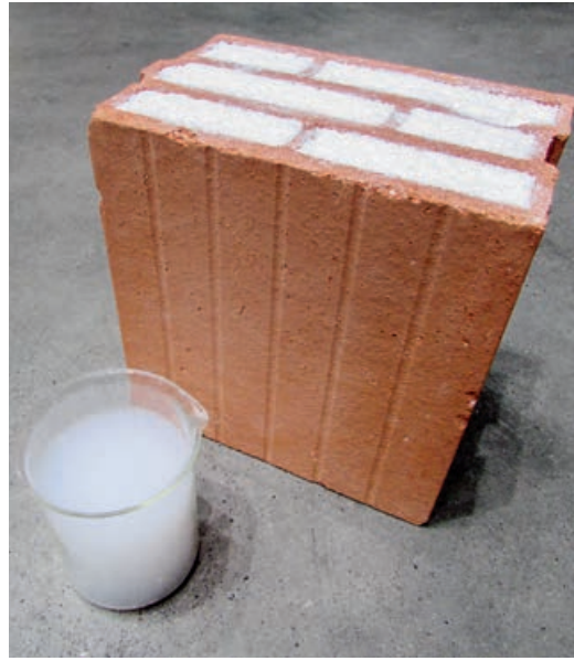
Projekte der Forscher: Holzfaserkomposit oder Backsteine mit Aerogel ausgeschäumt.
