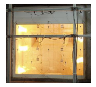
Ansicht der Festverglasung mit Rahmenverbreiterung bei Prüfstart. Die Abmessung dieser Konstruktion beträgt 3.0 Meter x 3.0 Meter. Das Brandschutzglas, welches im Verlauf der Prüfung eintrübt und aufschäumt, ist noch klar und lässt die Flammen der Ölbrenner im Versuchsofen gut erkennen.
