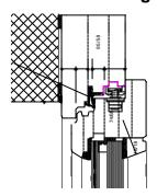
Die Rahmen- und Flügelteile werden in Eiche ausgeführt. Es stehen folgende Fenstersysteme zur Verfügung, welche brandschutztechnisch als gleichwertig betrachtet werden können:
